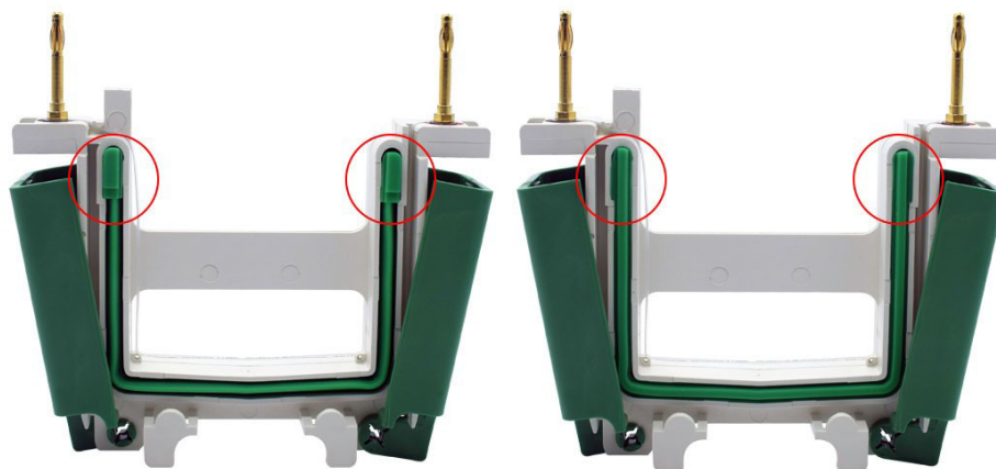
图1. 碧云天、Bio-Rad等公司的电泳槽U型硅橡胶密封条的突起结构图。由于碧云天的BeyoGel™ PAGE预制胶的该部位是平的，使其兼容几乎所有厂家的小型胶电泳槽，所以电泳时须将具有突起结构的硅橡胶密封条(左图)取出后反过来安装(右图)，使其没有突起的平滑面朝外，从而防止漏液。
